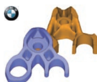
拓扑优化，刚度提高39%，应力降低60%，重量减轻21%
