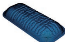
排气消声器条纹优化 提高振动频率
