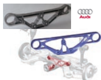
横向连杆拓扑优化 最大应力降低45%，减重10%
