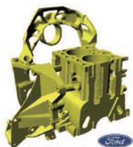
发动机架拓扑优化 考虑铸造拔模工艺要求
