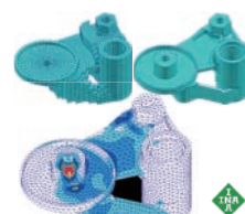
曲柄零件拓扑-外形联合优化 减重5%，最大应力降低34%
