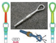
非线性接触条件下拉环外形优化 仅增重7%，最大应力降低33%
