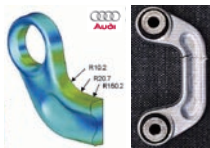
导向连杆外形优化，最大应力降低30%，大幅提高疲劳寿命
