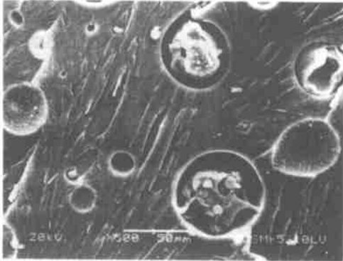
图 3 纯 UP 树脂固化试件断裂面
